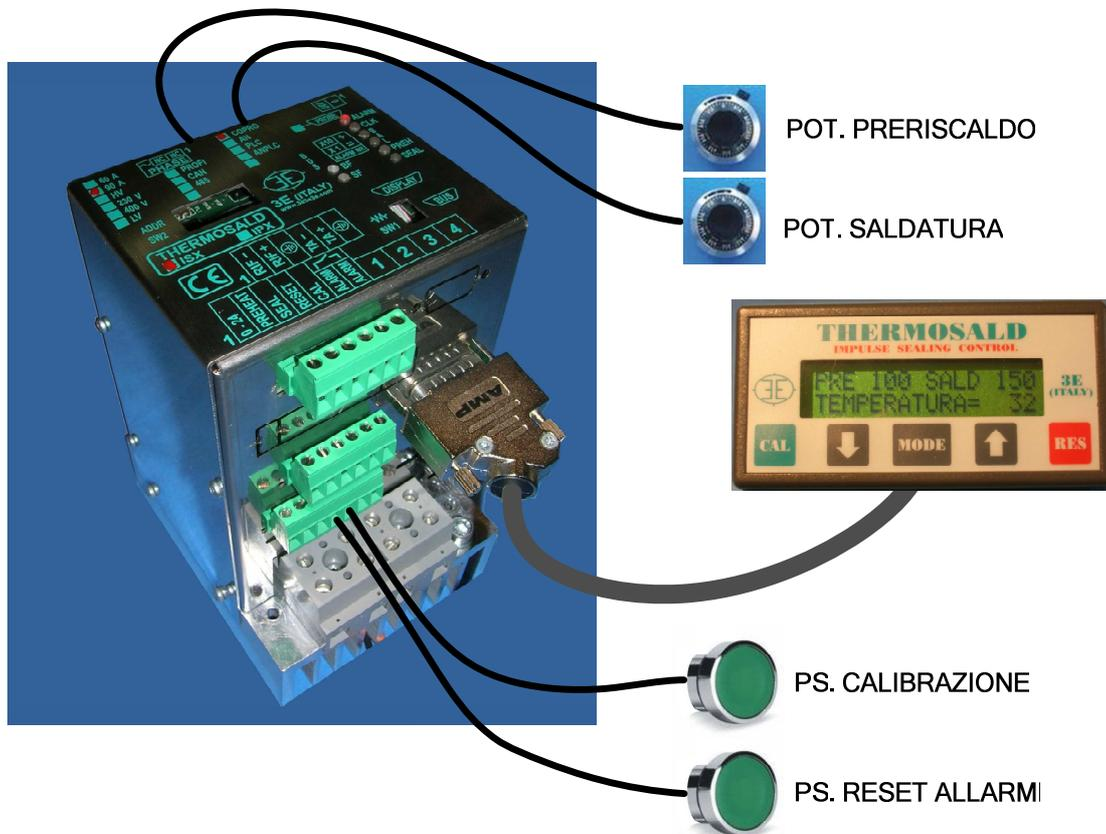
NOTA 1: per abilitare i potenziometri impostare il DATO MACCHINA CONFIGURAZIONE=1 potenziometri+display.
