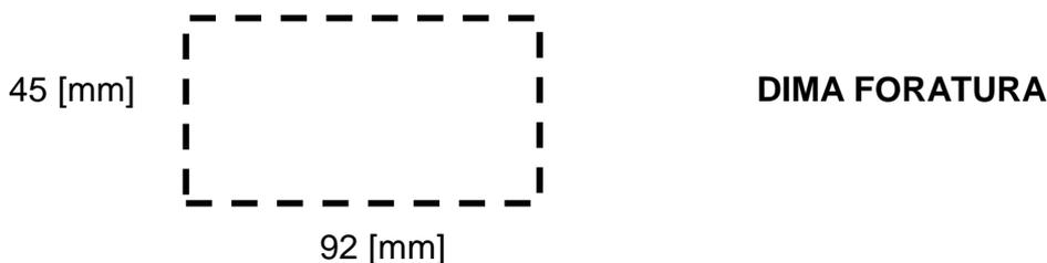
**NOTA: con protezione IP65, codice 3ES108Z=IP65, fare dima foratura 94mm x 47mm, dimensione esterna massima 102mm x 54mm**
