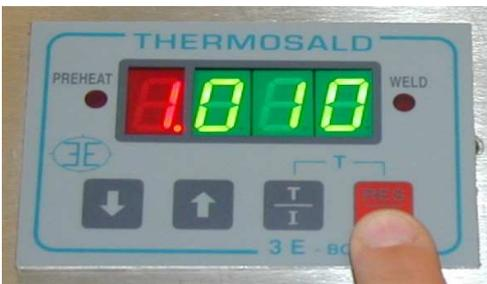
Auf dem Display erscheint die Schrift H100, um zu melden, dass die erste Erwärmungsphase bei 100 Grade gerade ausgeführt wird. Danach erscheinen nacheinander die Schrift H160, H100, H160, H100, H160, H100, um die Heiz- /und Abkühlungszyklen der Flachdrähte bei 160 und 100 Grade anzuzeigen. Nach Beendigung des Zyklus ist der Temperaturregler betriebsbereit. Der Burn-Zyklus läßt sich unterbrechen, indem man die Reset-Taste drückt.
