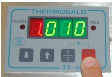
Auf dem Display wird die Schrift H100 visualisiert. Diese zeigt an, dass eine erste Erwärmungsphase bei 100 Grade gerade vorgenommen wird. Danach erscheinen nacheinander die Schrift H160, H100, H160, H100, H160, H100, um die Erwärmungs-/ Abkühlungszyklen des Flachdrahtes bei 160 und 100 Grade anzuzeigen. Nach Beendigung des Zyklus ist der Temperaturregler betriebsbereit. Der Burn-Zyklus läßt sich durch Drücken der Reset-Taste unterbrechen.
